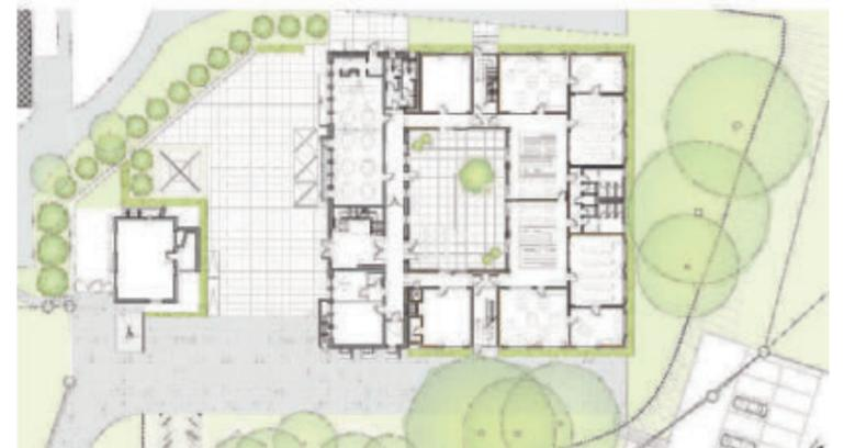
Der Lageplan der Grundschule mit dem Grundriss des Erdgeschosses: Der linke Teil (mit der Mensa links oben) besteht aus dem bisherigen Schulgebäude, in der Mitte liegt ein Innenhof und rechts oben und unten die insgesamt vier Räume für die Erst- und Zweitklässler. In den Ecken befinden sich Räume für Förderunterricht. Erreichbar sind die Klassen über Vorräume mit Lounge-Charakter. Lange Flure gibt es nicht mehr.
